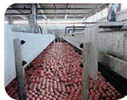
شکل ۷. نمایی از سطح محلول پوشیده شده با توپ های پلی اتیلنی
