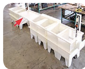
شکل ۱۱. استفاده از تخته ی مخصوص جهت جلوگیری از ریزش مواد بر روی زمین
