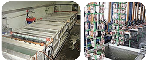
شکل ۸. نمایی از خطوط با آبکشی بعد از وان اصلی
