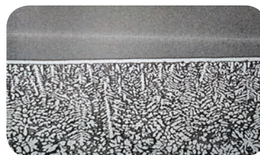
شکل ۷. ساختار دندردستی روی در لایه ی فشرده ی سطحی به ضخامت ۱۰۰ میکرون (بزرگنمایی تصویر ۵۰۰ برابر)
