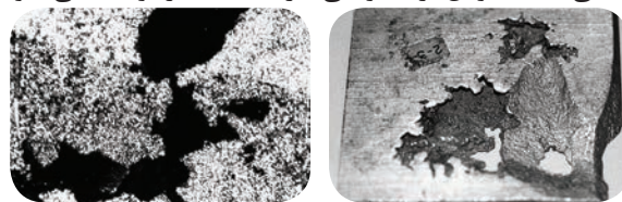
شکل ۴. تصاویری از عیب حفرات انقباضی
