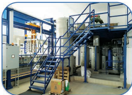
سیستم خنثی سازی پساب برای پساب های نیکل ، کروم و سیانور با امکان بازیافت آب به چرخه آبکاری با ظرفیت ۵۰ متر مکعب در روز
